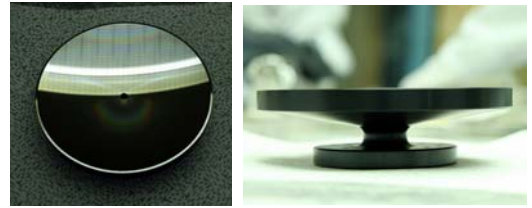
그림 8. 오프너 시스템의 주경의 구조. 마운트가 스트레스를 받는 경우에도 경면에 영향이 가지 않도록 목부분을 잘록하게 설계하였다.
