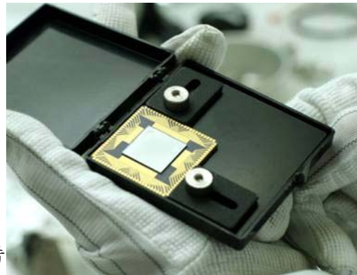
그림 1. InSb 512×512 Array (Raytheon사의 ALADDIN III Quadrant). 한국천문연구원 소백산천문대 근적외선 카메라 KASINICS에 사용한다. (사진제공: 한국천문연구원)
