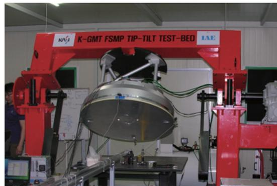
그림 7. 수직방향 측정용과 기울임 시험용 test-bed들 모습
