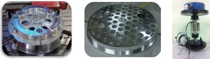
그림 6. 팁틸트 test-bed를 위해 제작된 유닛들의 모습. 왼쪽부터 알루미늄으로 가공된 미러셀, 역시 알루미늄으로 제작된 더미 미러, 중간에 있는 피에조 액츄에이터가 스프링으로 둘러싸여있고 맨 위에 로드셀이 결합된 축방향 지지대.
